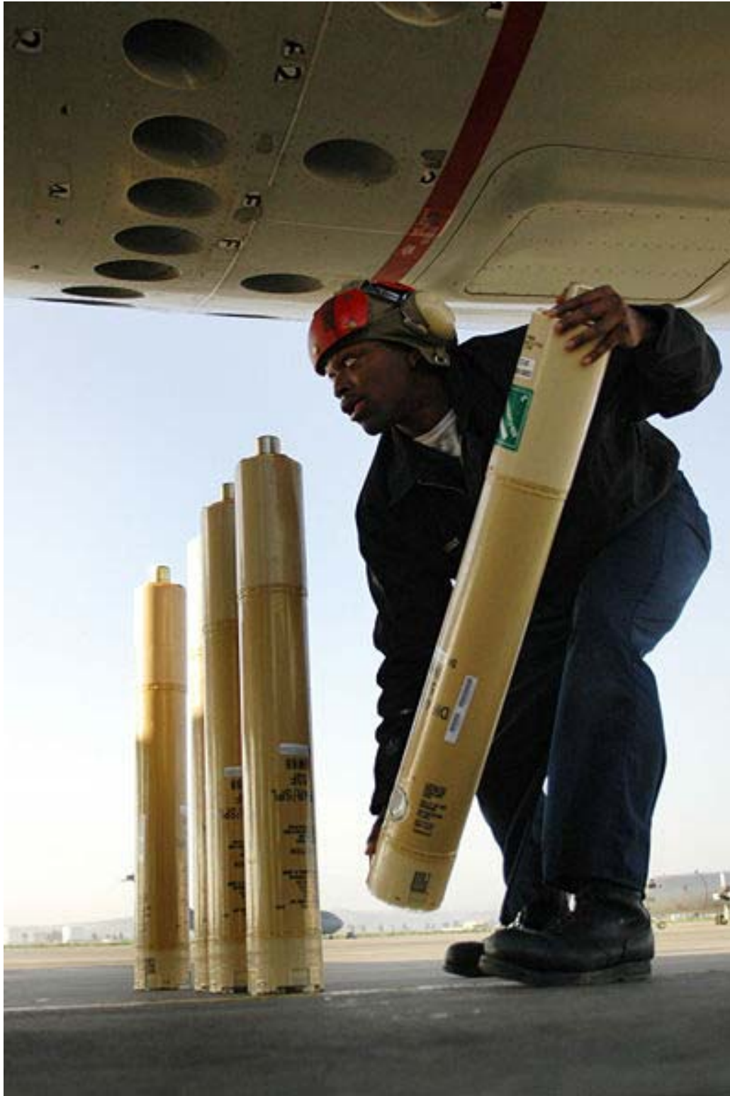
Figura 1: Operario cargando sonoboyas en un P-3 Orion
